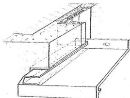
Die Länge der Aussenfensterbänke ist so zu wählen, dass die U-förmigen Endstücke zusammen mit den Zargenprofilen völlig eingeputzt werden.
